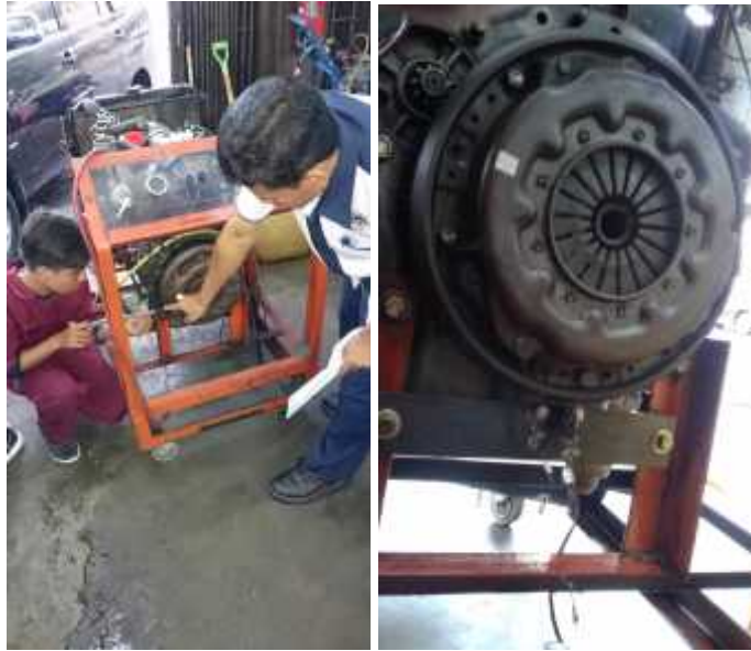
Gambar 5.8. Proses modifikasi fly wheel dan membuat kedudukan rpm sensor .
