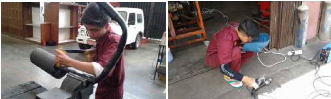
Gambar 5.6. Proses modifikasi exhaust manifold .
