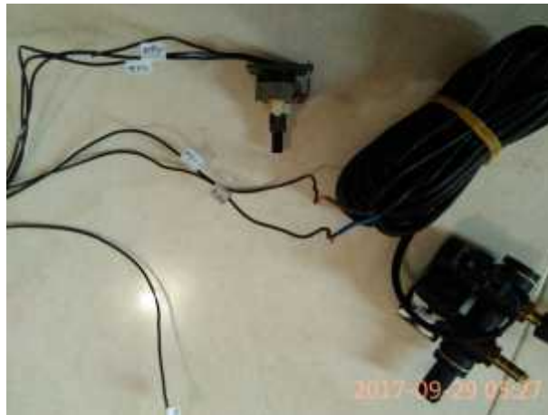
Gambar 5.3 Rangkaian injektor yang telah siap disambungkan dengan ECU.
