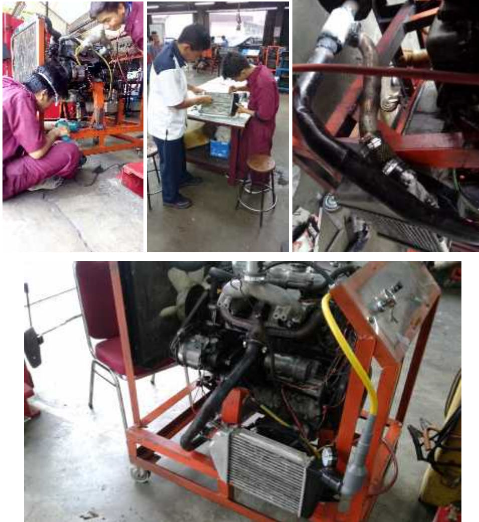
Gambar 5.7. Proses pemasangan rangkain sistem EGRICS pada mesin.
