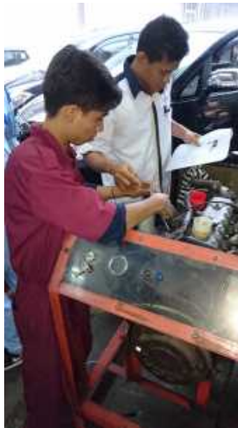
Gambar 5.5. Membuat lubang injektor pada intake manifold .
