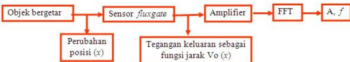
Gambar 7. Prinsip Kerja Sensor *Fluxgate* Sebagai Sensor Getaran
