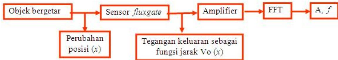
Gambar 3. Prinsip Kerja Sensor *Fluxgate* Sebagai Sensor Getaran
