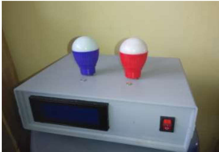
Gambar 1. Bentuk dari Box Kontrol instrumen kecepatan tendangan yang dikembangkan
