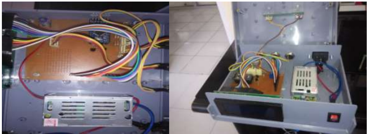
Gambar 2. Sistem Sirkuit instrumen kecepatan tendangan yang dikembangkan
