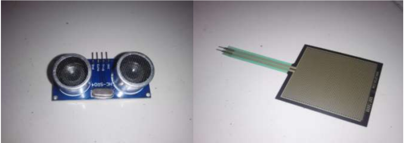
Gambar 4. Sensor yang digunakan dalam instrumen kecepatan tendangan yang dikembangkan
