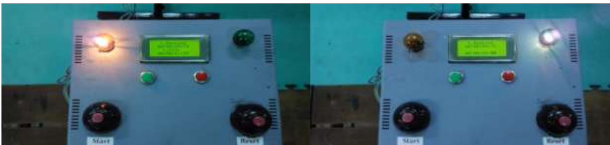
Gambar 5. Tampilan display instrumen kecepatan tendangan yang dikembangkan
