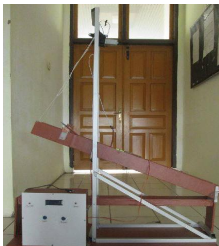
Gambar 12 Foto set eksperimen penentuan koefisien gesek statis benda pada bidang miring
