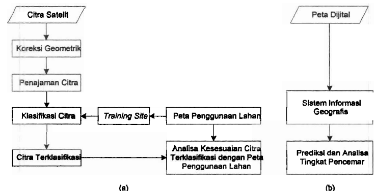
Diagram 1. Metodologi Penelitian (a) Klasifikasi Citra Satelit; (b) Sistem Informasi Geografis Untuk Prediksi dan Analisa Tingkat Pencemar
