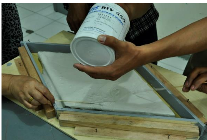
Gambar 26 Aplikasi silicon rubber ke dalam molding
