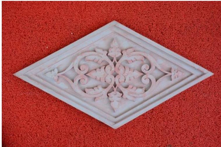
Gambar 34 Hasil cetakan terbuat dari bahan semen
