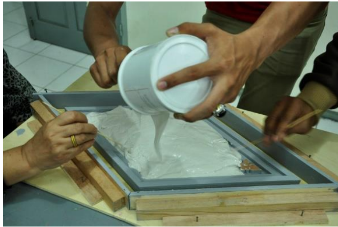
Gambar 25 Aplikasi silicon rubber ke dalam molding
