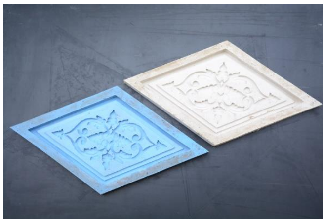
Gambar 29 Cetakan Silicon setelah dilepaskan dari molding
