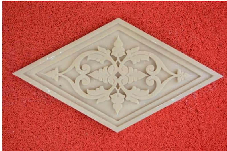
Gambar 37 Hasil cetakan terbuat dari bahan resin (fiberglass)
