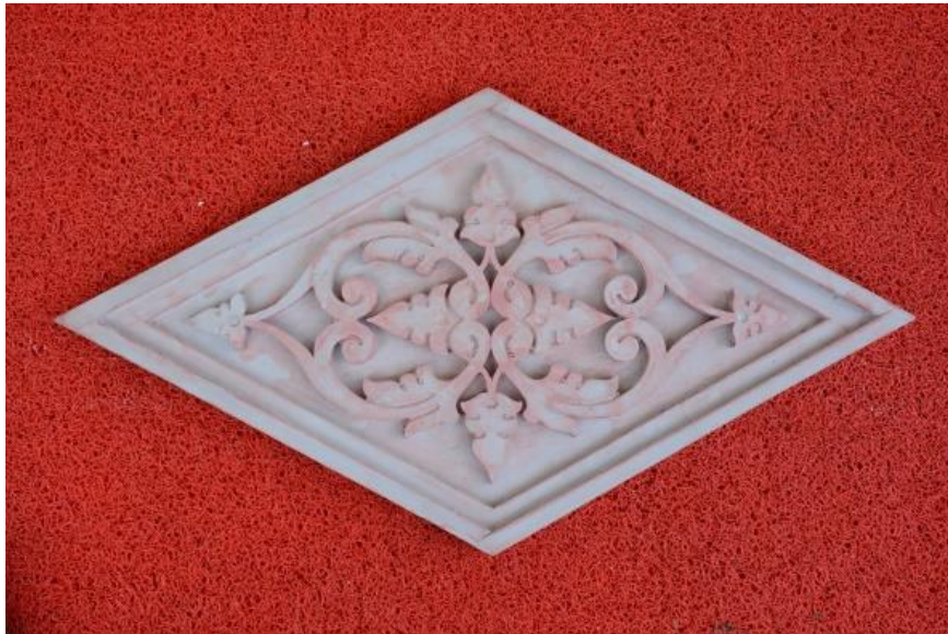
Produk prototipe dengan bahan cetak semen PC
