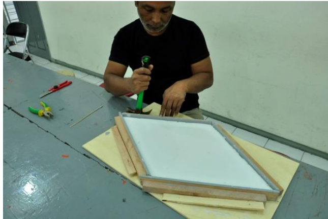
Gambar 27 Melepaskan silicon rubber dari molding
