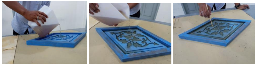
Gambar 36 Menuang resin ke dalam cetakan sampai rata dengan permukaan cetakan
