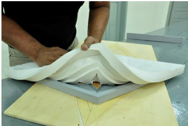
Gambar 28 Melepaskan silikonrubber dari molding
