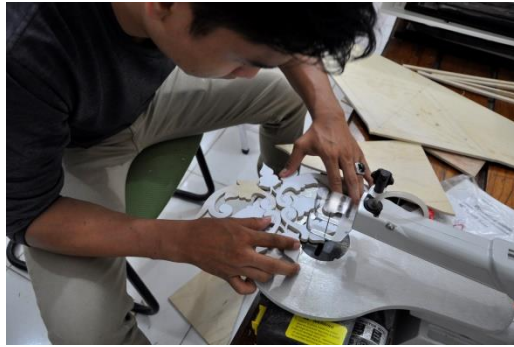
Gambar 16 Membuat molding menggunakan scroll jigsaw
