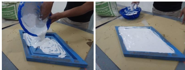
Gambar 39 Menuang cetakan dengan gypsum sampai rata dengan permukaan cetakan
