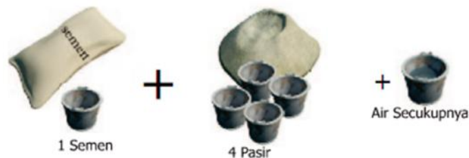
Gambar 2.1. Perbandingan semen, pasir dan air untuk mortar (Persyaratan Pokok Rumah Lebih Aman Terhadap Gempa, PU)
