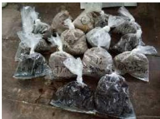
Sampel untuk uji kadar air
