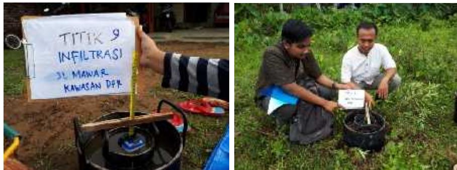
Gambar 6. Pelaksanaan uji infiltrasi dengan *Double Ring Infiltrometer*
