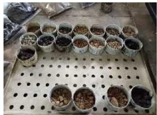
Uji kadar air tanah
